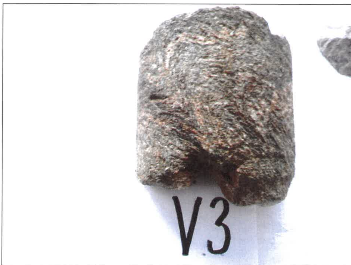
Foto č.14: Detailně provrásněný cordierit-biotitický migmatit slabě navětralý, masivní třídy R3-R2. Vrtné jádro z hloubky 7,00m, z vrtu V3.
