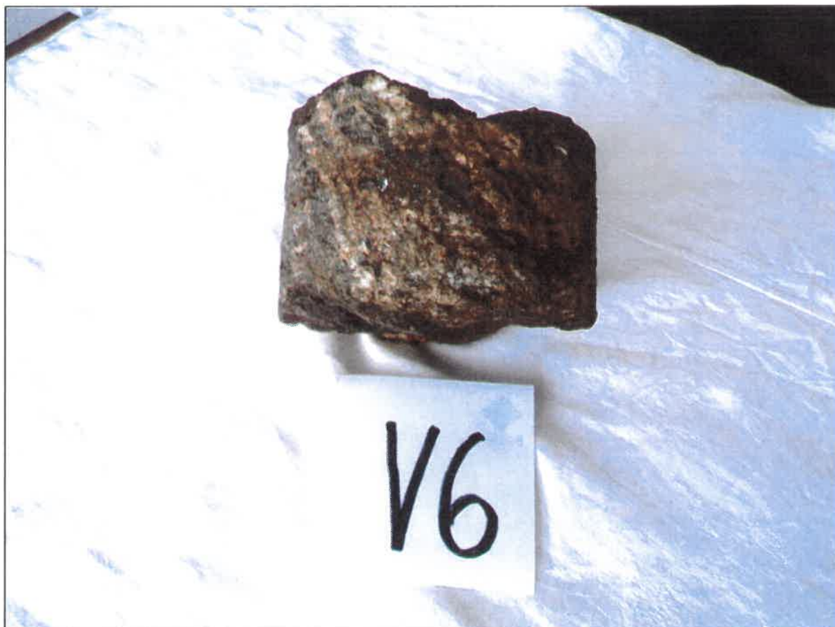
Foto č.16: Vrtné jádro z vrtu V6 z hloubky 7,00m tvořené slabě zvětralým cordierit-biotitickým migmatitem s šikmými foliacemi a s proužky křemen-živcového metatektu.
