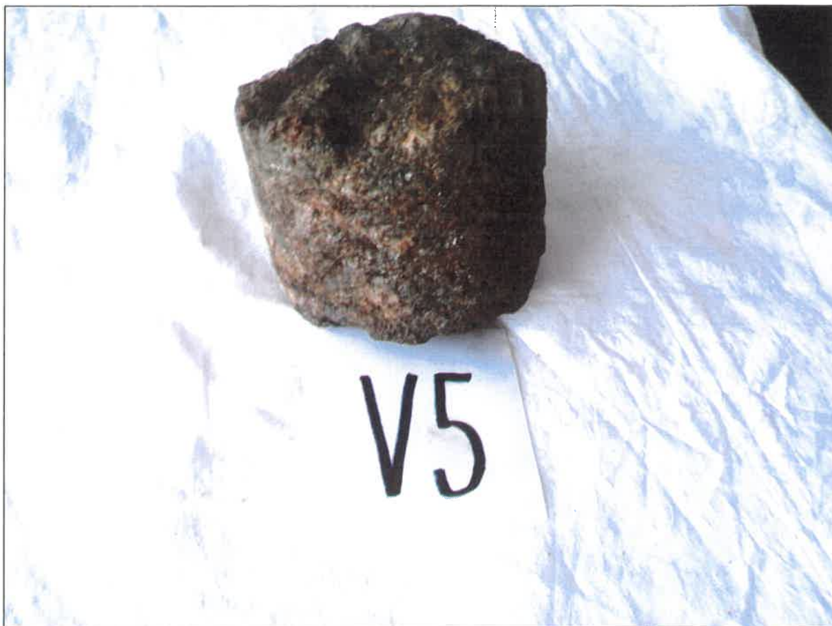
Foto č.15: Vrtné jádro z vrtu V5 z hloubky 7,00m tvořené slabě zvětralým cordierit biotitickým migmatitem třídy R3-R2.
